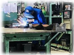
部品溶接工程
